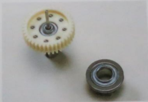
03系OPのボールデフ。樹脂のハウジングに収まるのでボールの動きはそう重くならない
