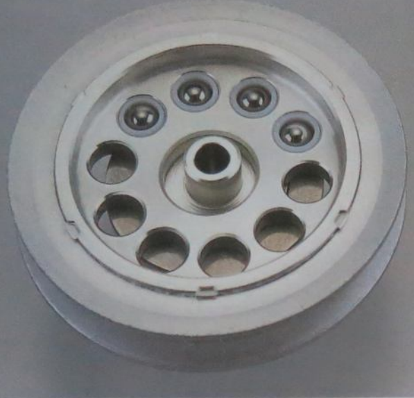
414のリヤ用ボールデフ。仕組みはTA03系と同じだがボールがテフロンカラーでフローティングされ、デフケースに接することでロスを抑えている
