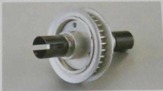
414のフロント用32Tワンウェイプリー。本体は高精度アルミ製で、これが直接ベルトで回される
