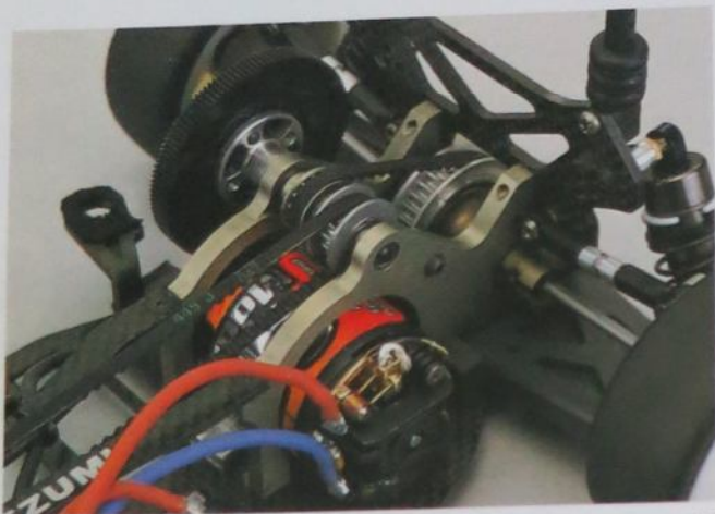
414のキットでは15Tのセンターワンウェイブリーが標準。初期反応と燃費が上がり、一番曲げられる組み合わせ
