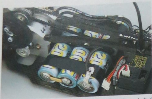
バッテリーは左右に3セルずつを振り分けたセパレートタイプをグラステープで固定。ストレート型も同様に搭載可能だ
