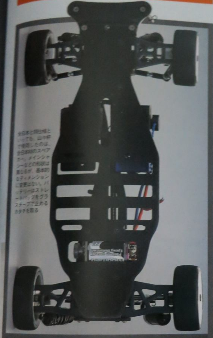
全日本選手権優勝経験のスペアカーをベースに作り上げた前住選手のマシンの要諦、結合部をゆるめ、基本的なセッティングは変えていないというが、コーナーのRが比較的小さいサーキットということから、サスペンションのスプリングを柔らかくして、ロールを積極的に使い、曲がりやすい仕様にしたという。
