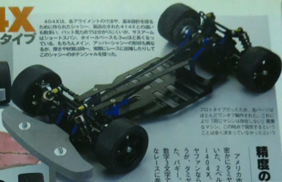
サスアームが短く、タミヤ・ツーリングカー用のタイヤ&ホイールが装着されたプロトタイプ。ここからまた別の展開が?!
