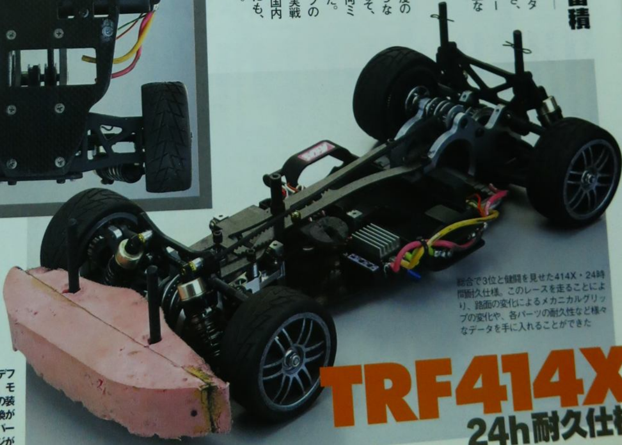
24時間レースの規定、バッテリーはストレートバック仕様に合わせ、メインシャシーを製作。形状は振り分けバッテリー用と全く異なるなり、24時間を走る上での強靭な剛性が必要だったことが分かる
