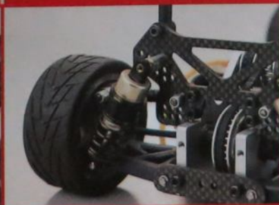
24時間耐久仕様のリヤダンパーまわり。アームの取り付け位置が異っている
